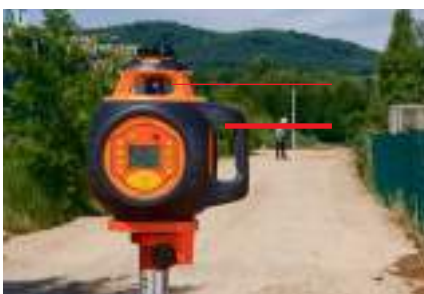
Fig. 4 - Funzione TRACKING per pendenze e raccordi
