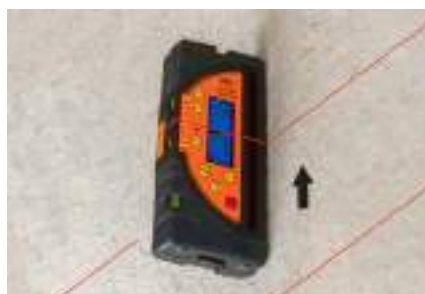
Fig. 5 - Ricevitore FR 77M con funzione TRACKING e misura in mm in modalità orizzontale
